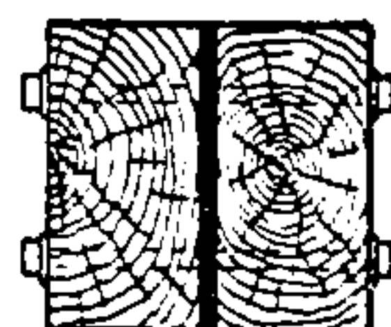
Fig. 228. Fitch-Plate Girder
