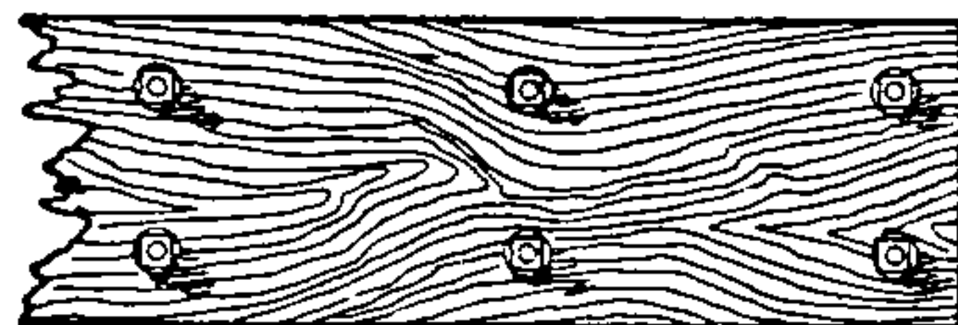
Fig. 228. Fitch-Plate Girder
